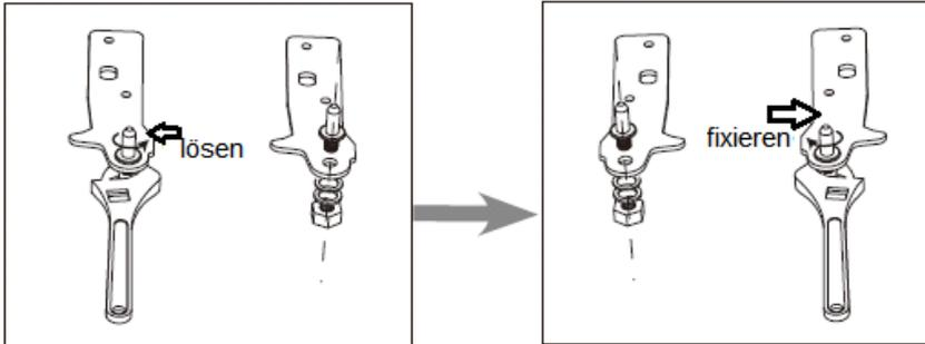
Den Stift vom unteren Scharnier lösen, das Scharnier um 180° drehen und den Stift wieder einstecken.
