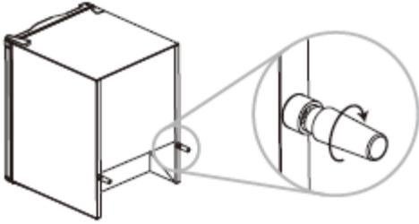
Zur Einhaltung der Abstände und zur Erreichung der angegebenen Energieklasse sind die beigegefügtten Abstandshalter am Gerät anzubringen. Sie werden direkt hinten am Gerät fixiert (siehe Zeichnung Fig.3).
