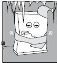
Im Kühl- und Gefrierraum I kann sich nach längerem Gebrauch eine Reif- bzw. Eisschicht bilden. Erreicht diese Eisschicht eine Dicke von 6 – 8 mm, muss das Gerät abgetaut und gereinigt werden. Eine zu starke Reif- bzw. Eisschicht erhöht den Energieverbrauch.
